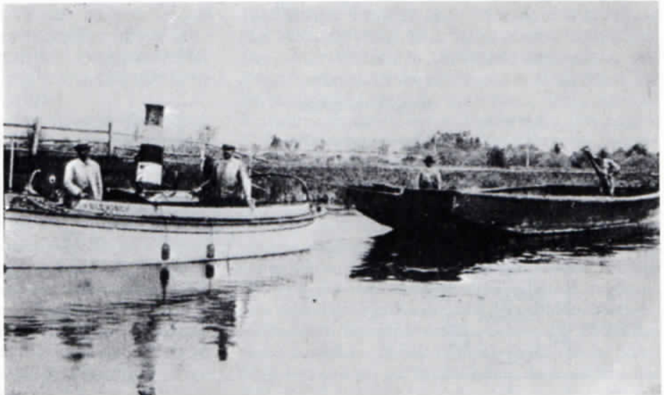
Abb. 1: Das 1912 erbaute Dampfmotorboot beim Schleppen eines Lastkahnes im Oberwasserkanal in Olching. Ausschnitt aus einer Postkarte.
