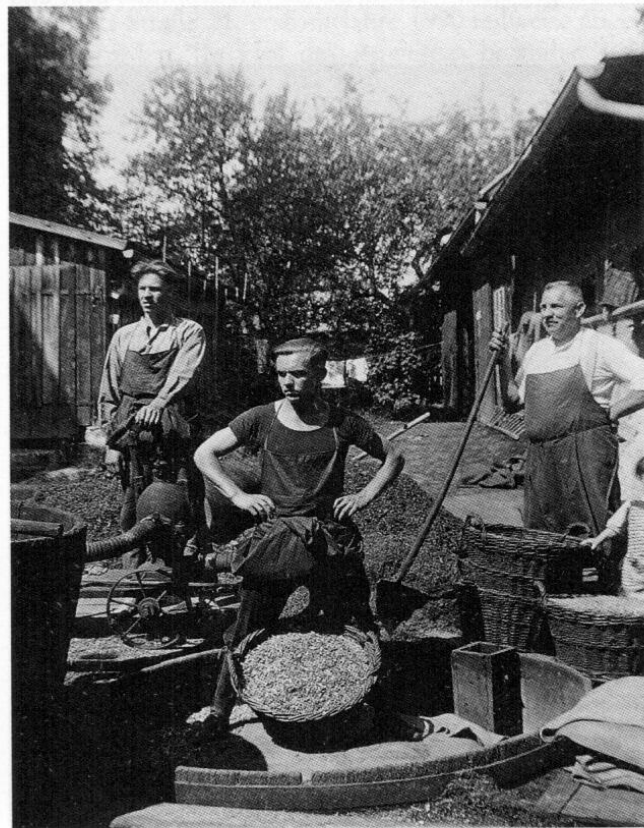
Abb. 8: Beim Versetzen der Häute mit Lohe im Hof der Werkstatt im Jahre 1937. Von li.: Joseph Schiela, Anton Schiela jun. und Anton Schiela sen.
